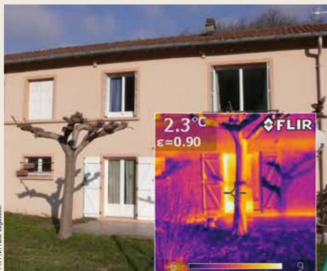
Une photo infrarouge indique aux habitants les pertes d'énergie.
