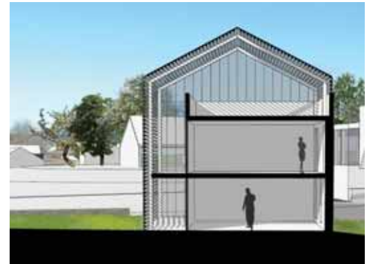
Logements collectifs passifs : verrière toute hauteur avec la structure comme brise-soleils.
