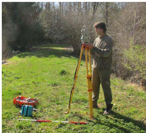
Figure 3 : Relevés topographiques avec le théodolite (ancienne forge de Firbeix)
