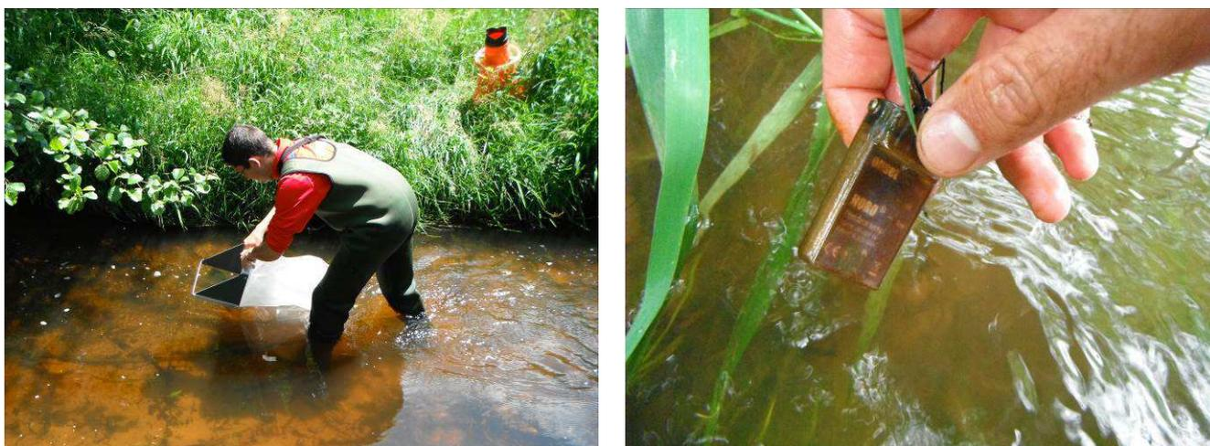
Figure 2 : Prélèvements IBGN au filet zurber et boîtiers enregistreurs de température
