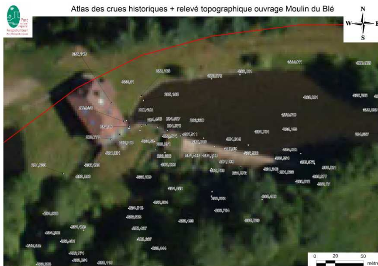
Figure 2 : Exemple de nuage de points relevés sur le site du Moulin du Blé
